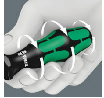
De voor de greep gebruikte harde materialen garanderen snelle hand-wisselingen zonder het gevaar van het "plakken" van de huid aan de greep. De rondom gevormde harde zones met grootste diameter lopen soepel door de hand.
