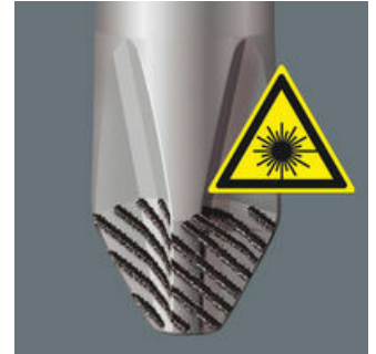
Door een gebundelde laserstraal wordt er een scherpe oppervlaktestructuur ingebrand. Wera Lasertip bijt zich in de schroefkop vast en voorkomt het wegglijden uit de Sleuf-, Phillips- en Pozidrivschroefkop.
