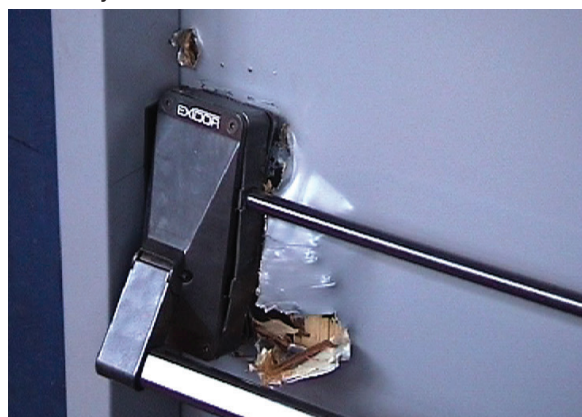
Aangezicht aan de binnenzijde na 15 minuten. De 4e schoot houdt de deur nog altijd veilig dicht.
