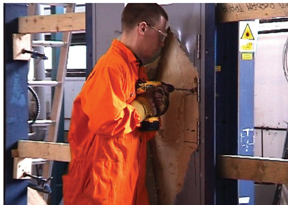
Na het verwijderen van het deuropervlak, wordt een boor gebruikt om het beslag aan de binnenzijde aan te vallen.
