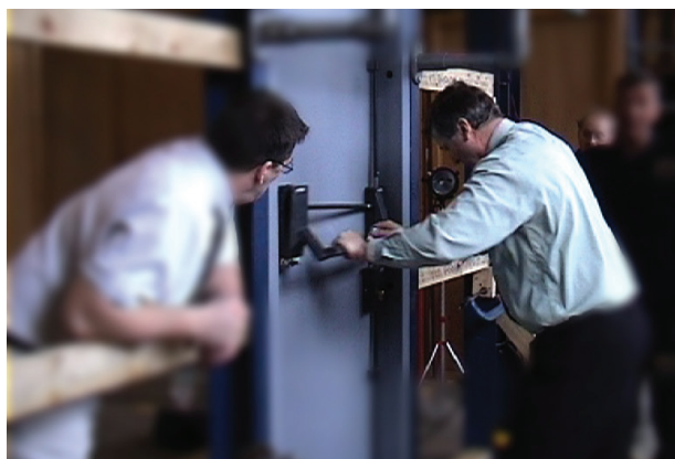
Aangezicht aan de binnenzijde na 20 minuten. Het mechanisme van het beslag is gaan klemmen waardoor toegang onmogelijk is geworden.
