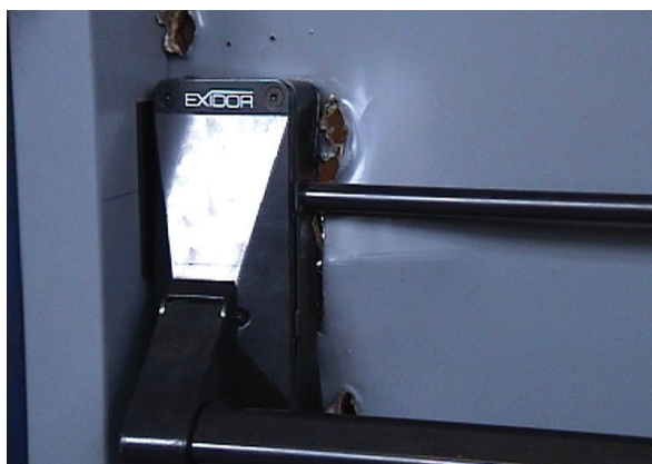
Aangezicht aan de binnenzijde na 10 minuten. De 4e schoot houdt de deur nog altijd veilig dicht.
